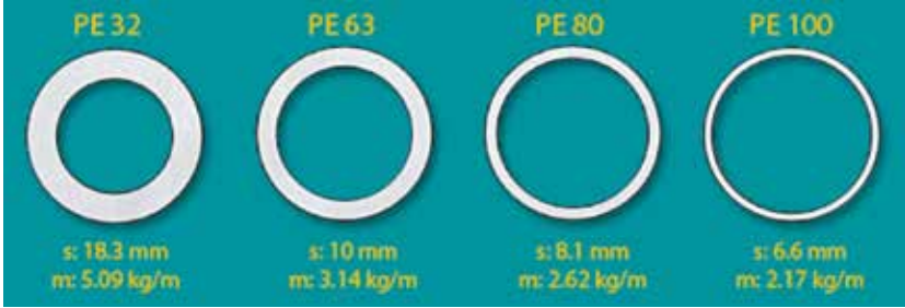
Şekil 3 Polietilen Boruda Hammaddeye Göre İç Çap Değişimi
